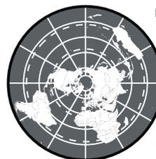
**Polar-Projektion:** Azimutalprojektion (3a) – Ein gedachtes Blatt Papier wird an einen Pol (hier Nordpol) angelegt. Die Oberfläche wird so auf das Blatt projiziert, wie sie durch eine Lichtquelle vom anderen Pol aus erscheinen würde. Diese Darstellung zeigt in den polnahen Gebieten starke Verzerrungen.
