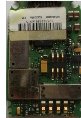
Abb.3: Handyplatine mit Kondensatoren (enthalten aus Coltan gewonnenes Tantal)
